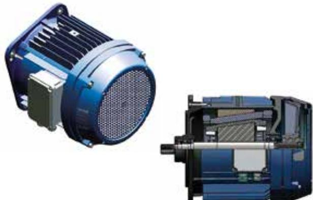
Электрический асинхронный трехфазный двигатель с 1 или 2 скоростями, коническим ротором и встроенным коническим тормозом, который приводится в действие благодаря винтовой пружине. Тормоз активирует осевое смещение ротора при подаче напряжения.
