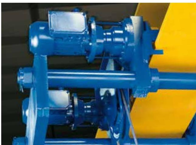
Тележка компактного размера состоит из двух электрических двигателей, установленных на планетарные редукторы. Тележка с ведущим валом и редуктором, установленным непосредственно на вал привода колес, исключает необходимость использования внешних редукторов.
