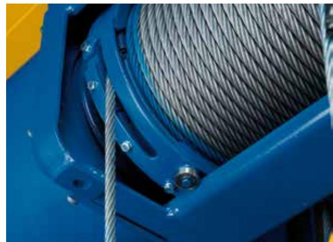
Направляющее устройство троса состоит из двух элементов: направляющего кольца и пружины сжатия. Пружина обеспечивает правильное направление троса в отверстия барабана, а направляющее кольцо всегда удерживает трос в правильном положении, не давая ему отклоняться от отверстия барабана. Направляющее устройство гарантирует прочность конструкции и оснащено высококачественными подшипниками. Перемещение направляющей вдоль барабана активирует ограничитель «вверх/вниз».
