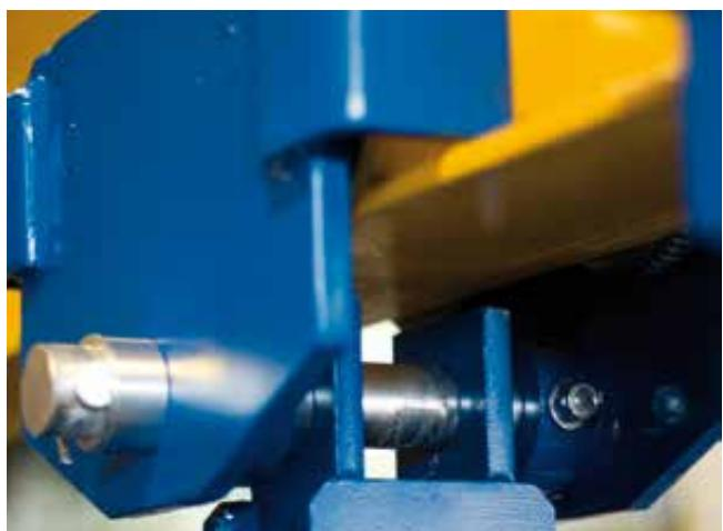
Тележка стандартного размера позволяет использовать таль непосредственно под краном/краном-балкой или параллельно ей. Таль подвешена с использованием приводной тележки.
