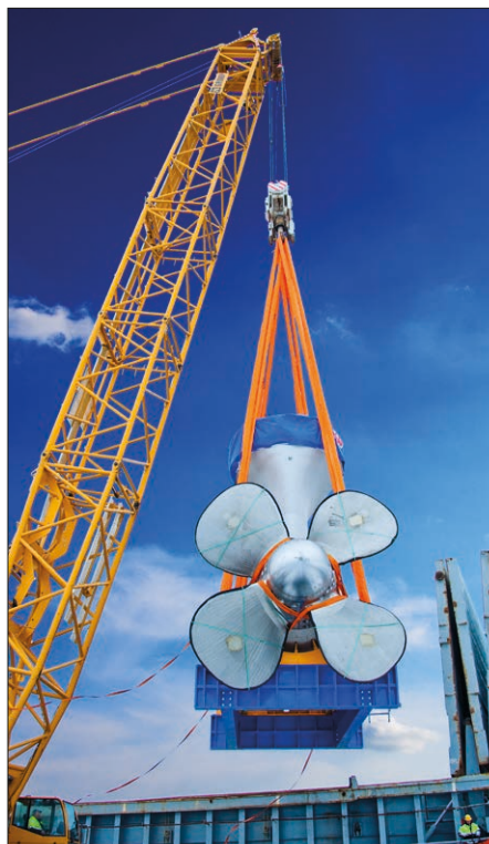
На фотографии: подъём винта весом 305т стропами Haklift.
