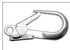
Крюк страховочный наружные размеры 240 мм, зев 60 мм, маркировка EN 362 Код изделия: AZ023
