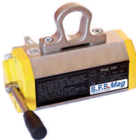
Для включения и отключения магнита достаточно перекинуть ручной рычаг. В активированном состоянии рычаг управления застопорен с помощью предохранительной блокировки для предотвращения случайное размагничивание. Из соображений безопасности при выборе магнитов следует учитывать предполагаемые условия эксплуатации, такие как качество поверхностей, легирование материала и толщину плит (таблица).
